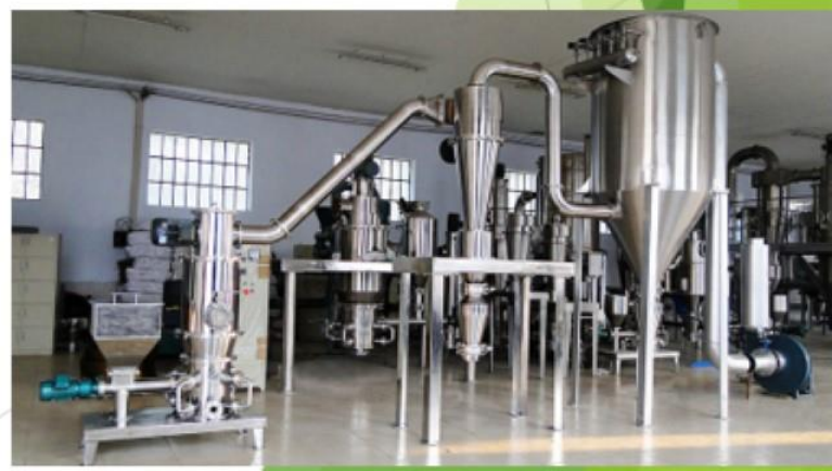
1.送料系统 2.冲击磨主机 3.旋风收集器 4.除尘器 5.引风机 6.电气控制系统
