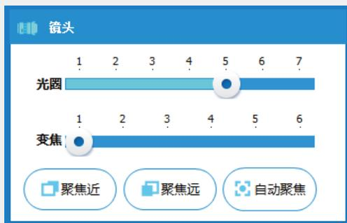
如左图所示, 光圈和焦距可通过拖动滑块来进行调整, 点击下方按钮, 可以对微调焦距。
