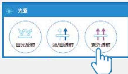
如果您使用的是 GenoSens 2000 Touch 系列一体式凝胶成像系统，您可以在光源选项中，长按紫外透射按钮，打开紫外透射台。（如左图所示）
