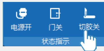
如果您希望通过电脑版的采集软件打开紫外透射，您可以点击状态指示栏中的切胶开关打开紫外透射。（如左图所示）
