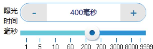
曝光时间越长，背景越亮。用户可以在打开预览模式的情况下，根据实际情况调整曝光时间。
