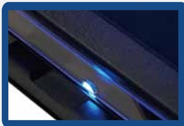
当紫外透射台正前方的指示灯亮起时，代表紫外透射已经打开，请务必注意对紫外的防护，避免肉眼直视！
